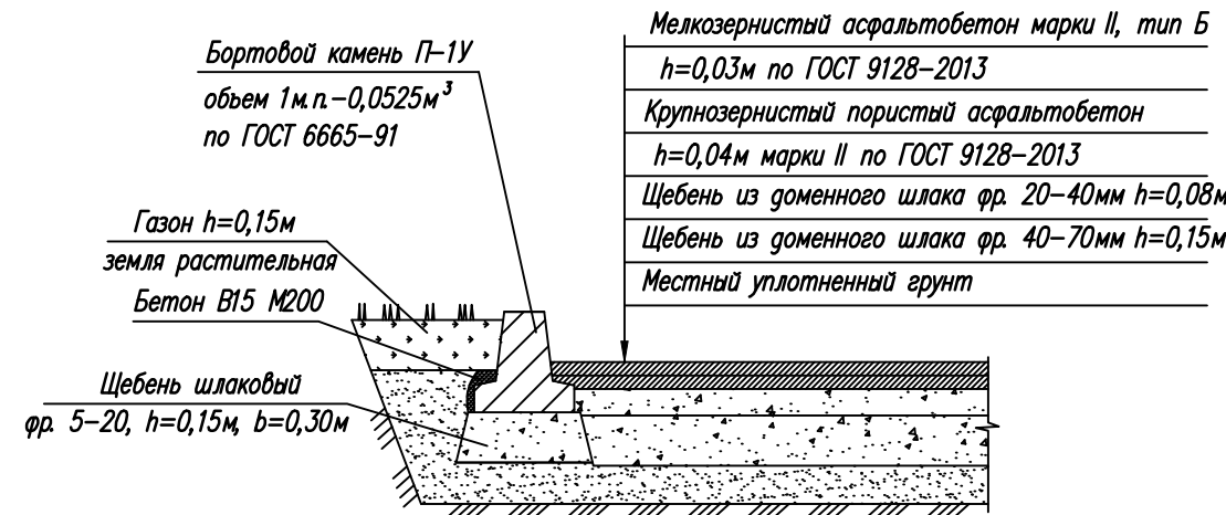
Схема 2 Конструкция дорожной одежды. Новое покрытие.
